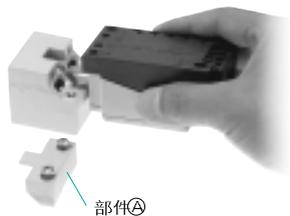
③ 侧面时, 按规定的方向旋转后, 嵌入外壳本体, 可旋转角度0~270°中的90°。请注意, 不要随意转动。
