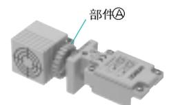
④ 置于侧面后, 向规定方向旋转, 然后将部件A安装在壳体外壳上, 并嵌入检测探头。(可回转角度在0~345°中的15°。请不要随意旋转。)
